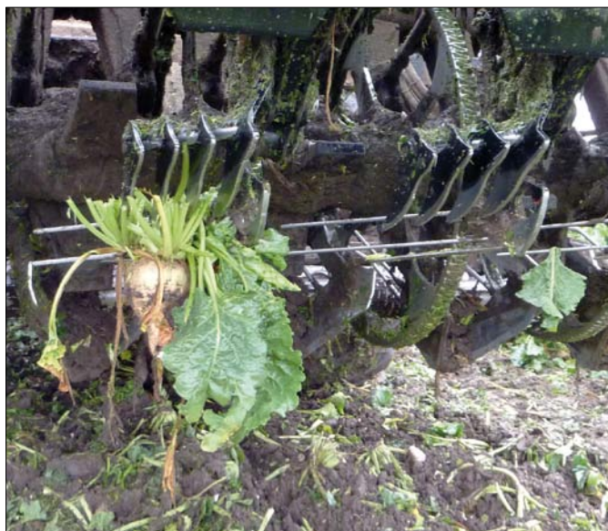
Obr. 1. Pasivní nůž a vyorávací ústrojí sklízeče cukrové řepy
