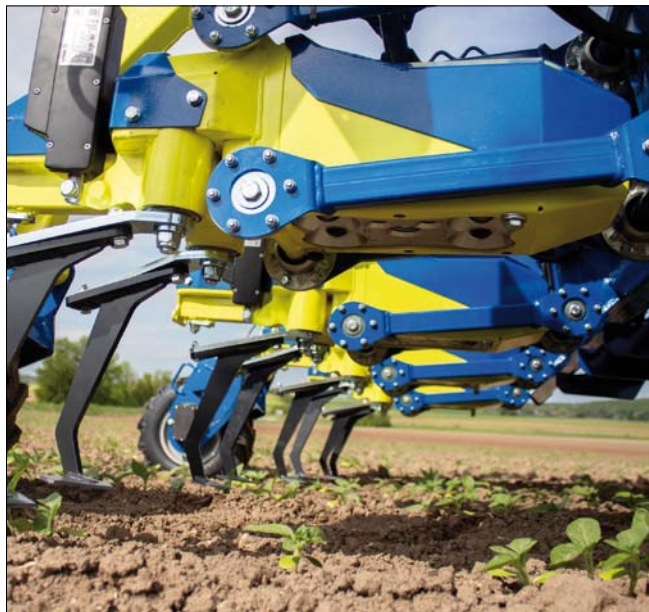
Obr. 11. Moderní řádková plečka Ullmanna vybavená AI technologií a strojovým viděním s rozpoznáním plodiny
