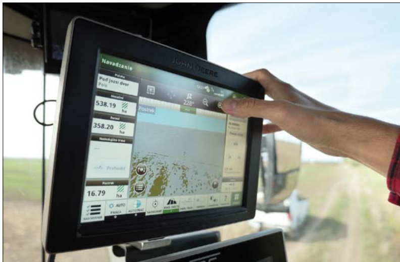
Obr. 7. Optimalizovaná mapa se zónami určenými k ošetření je instalována do ovládání postřikovače (foto CultiWise)
