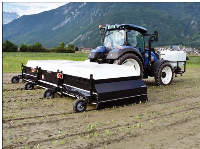
Obr. 2. V řádkových kulturách, jako je cukrovka, je ultrapřesná aplikace nejefektivnější (foto Ecorobotix SA)
