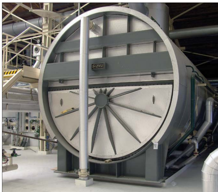
Obr. 7. Horizontální kontinuální zrnač KNK 32 v cukrovaru Dobruška
