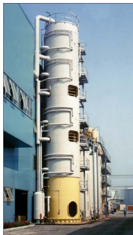
Obr. 8. Vertikální kontinuální zrnač BMA
