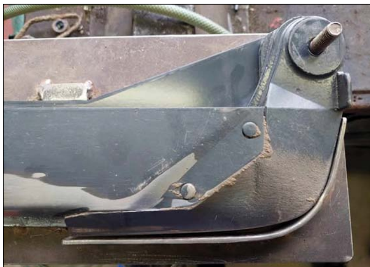
Obr. 5. Míru opotřebení botek nám může pomoci indikovat i podomácku vyrobená pomůcka (úchyt botky), která kopíruje tvar nové botky (výroba a foto: ZEOS Lošany)
