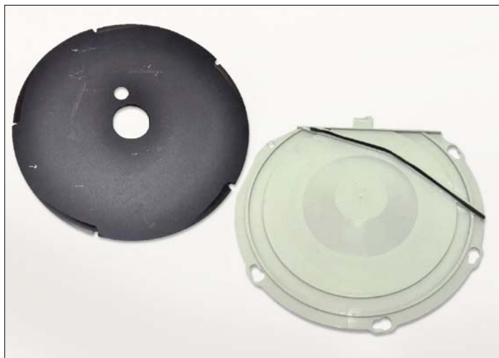
Obr. 6. Výsevní disk a jeho plastový kryt (poklička)
