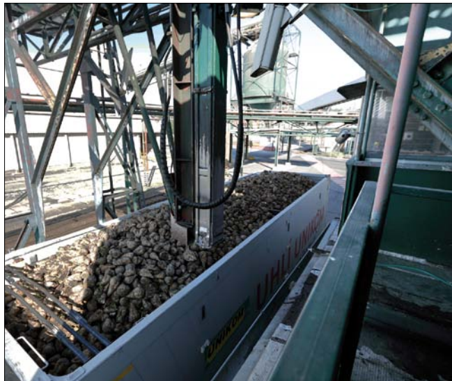
Obr. 5. Odebrání vzorku řepy automatickou sondou Rüpro
