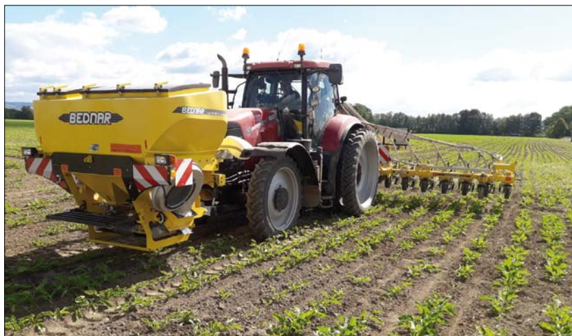
Obr. 9. Kromě rozrušení půdního škraloupu a likvidace plevelů lze speciální plečkou s RTK naváděním provést rovněž přihnojení variabilní dávkou dusíkatých hnojiv podle aktuálního stavu porostů detekovaného N-Sensorem (foto T. Javor)
