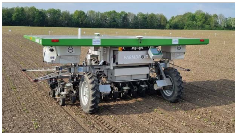
Obr. 15. Farmdroid – polní robot na solární pohon
