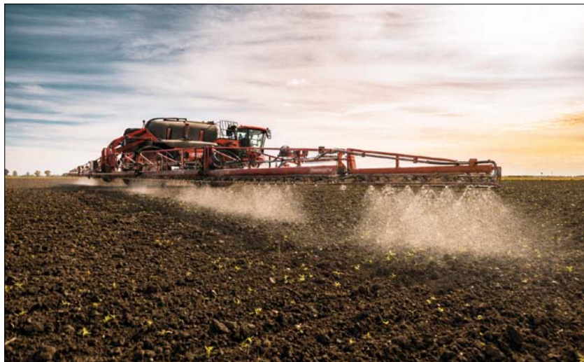
Obr. 8. Postřikovač aplikuje pouze na určených detailních místech pozemku (foto CultiWise)
