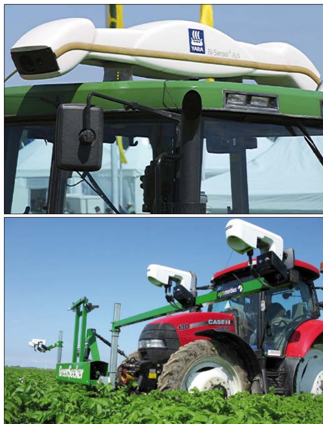
Obr. 12. Senzory – Yara N-Sensor na instalovaný kabině traktoru (nahore) a senzory Trimble GreenSeeker (dole)
