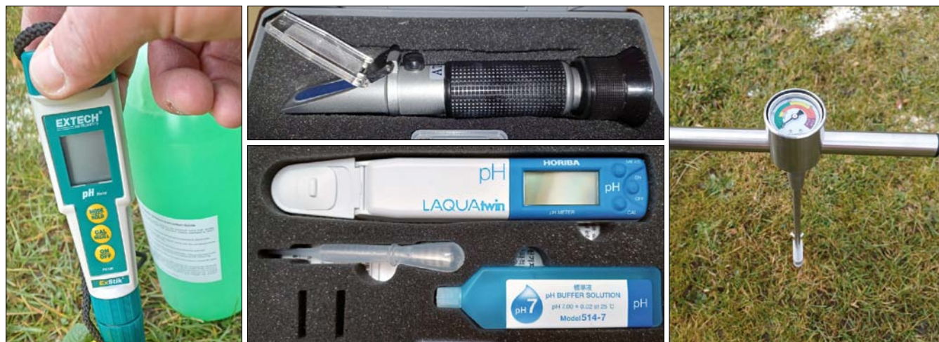
Obr. 16. Drobné farmářské přístroje (půdní pH metry, penetromerty ad.) pomohou s průběžnou orientací při vedení porostů (foto V. Jirka)
