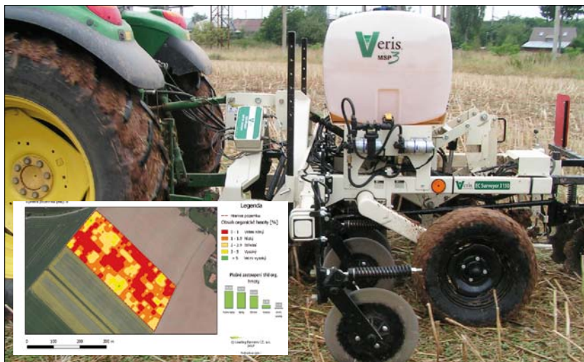
Obr. 10. Systémy jako je Veris umožňují velmi podrobné rozborů půdy přímo za jízdy po pozemku (foto V. Jirka, ortofoto ČÚZK)
