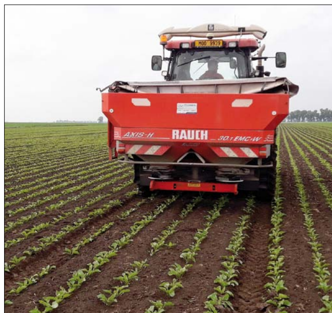
Obr. 4. Aplikace variabilní dávky granulovaného NS hnojiva za pomoci řízení dávky N-Sensorem (foto T. Javor)
