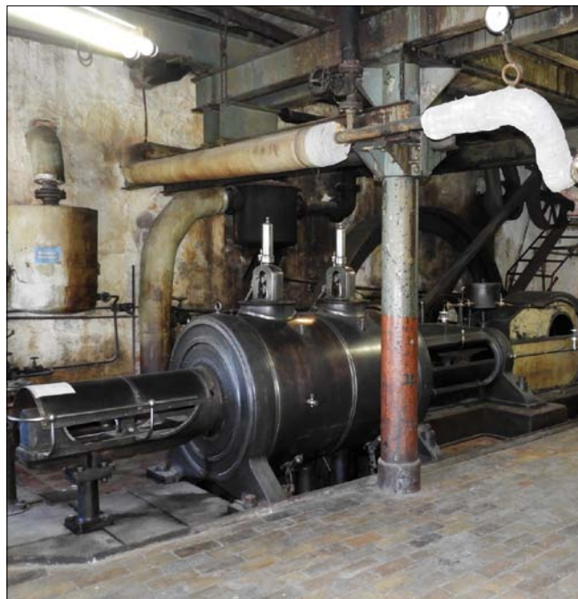
Obr. 4. Parní stroj BMA (1921) pro pohon některých zařízení rafinerie
