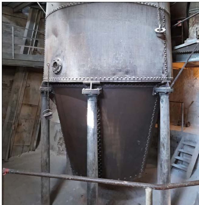
Obr. 2. Vápenka z roku 1898 s ručním plněním i vyprazdňováním
