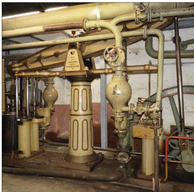
Obr. 3. Čerpadlo na vápenné mléko s parním pohonem (1882)
