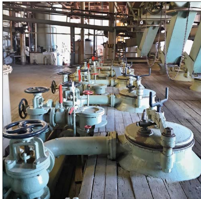
Obr. 1. Horní část difuzní baterie z roku 1906 (kapacita 620 t·d -1 )
