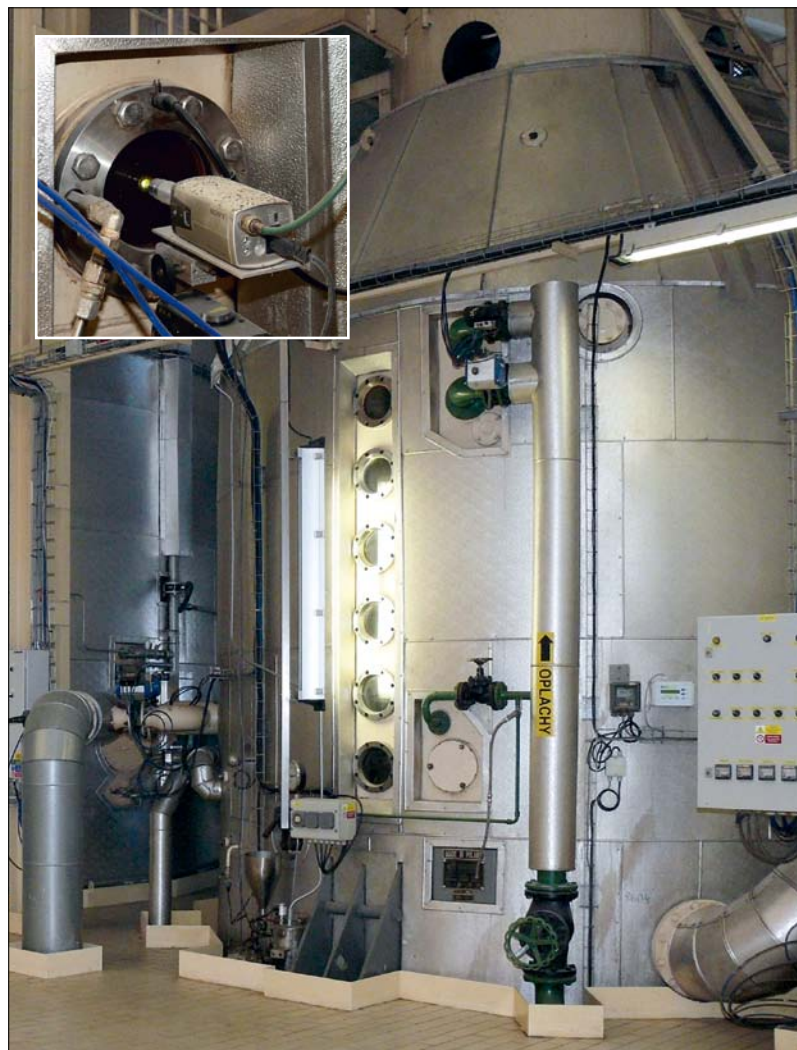
Obr. 17. Zrnič z varny cukrovaru Dobrovice, Tereos TTD, a. s., ve výřezu vlevo nahoře videokamera (foto M. Kmínek)
