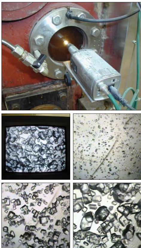
Obr. 15. Sledování krystalizačního procesu v zničích v cukrovaru
