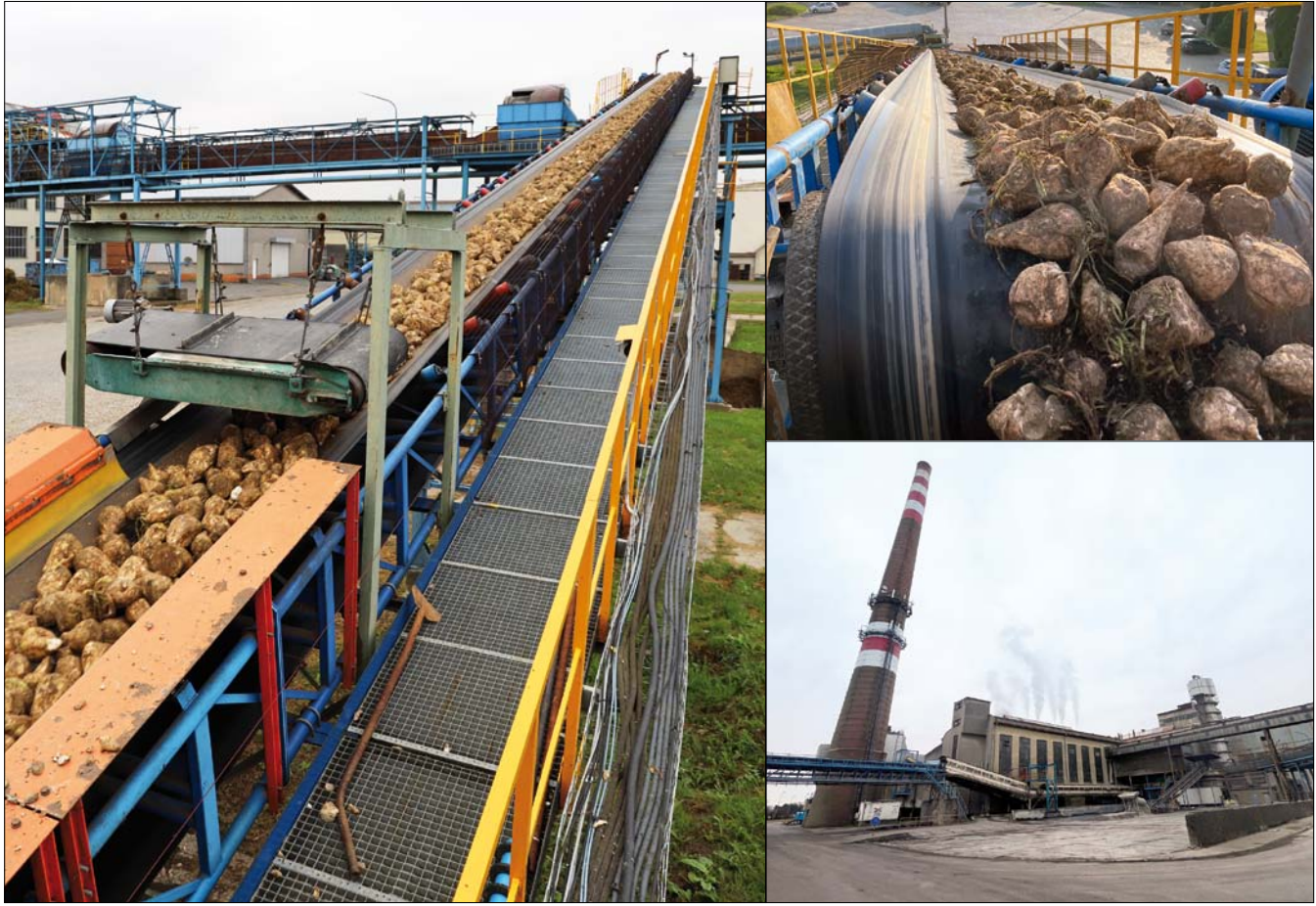
Obr. 8. Z kampaně v opavském cukrovaru: transport řepy a poslední pára z uhelné kotelny po ukončení kampaně (vpravo dole)
