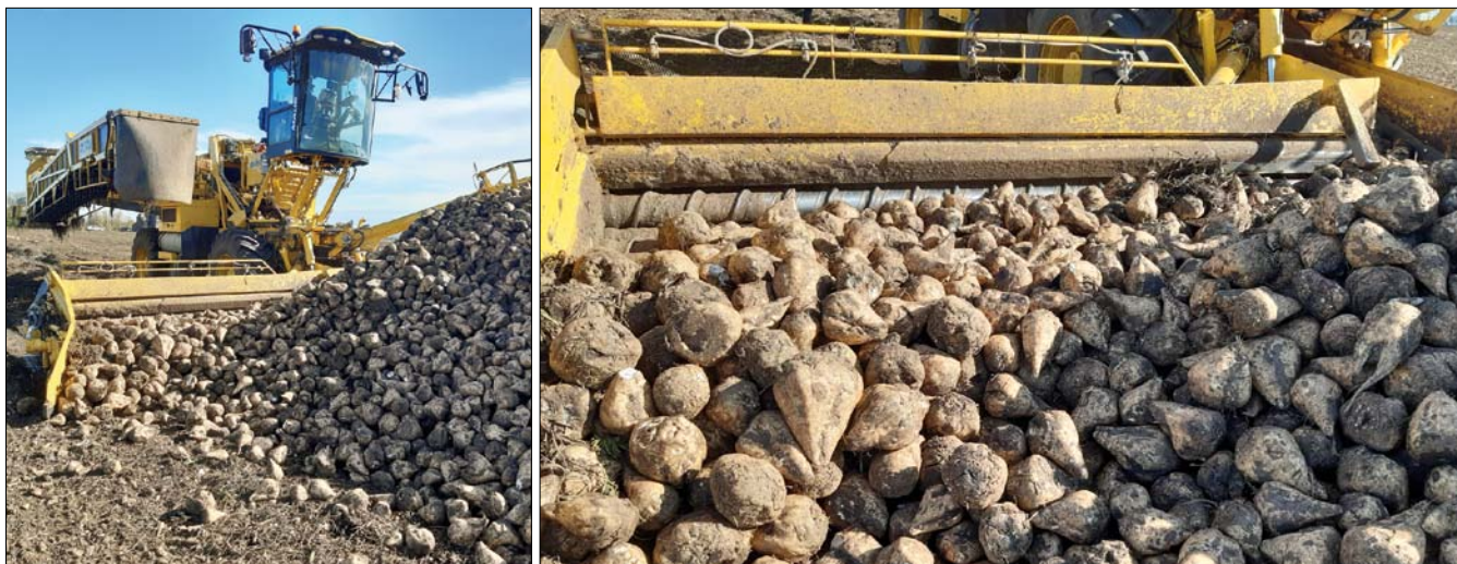
Obr. 1. Šnekové válce příjmového stolu čistícího nakladače cukrové řepy
