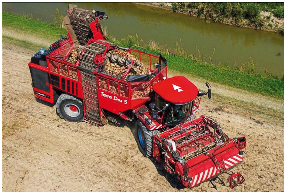
Obr. 3. SmartTurn umožňuje plně automatické otáčení na souvrati – včetně zvednutí a spuštění sklízecího adaptéru a přesného řízení stroje
