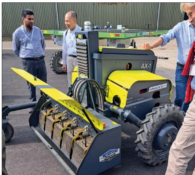
Obr. 2. Ukázka robotické techniky – bodový postřikovač a robotická plečka v pozadí
