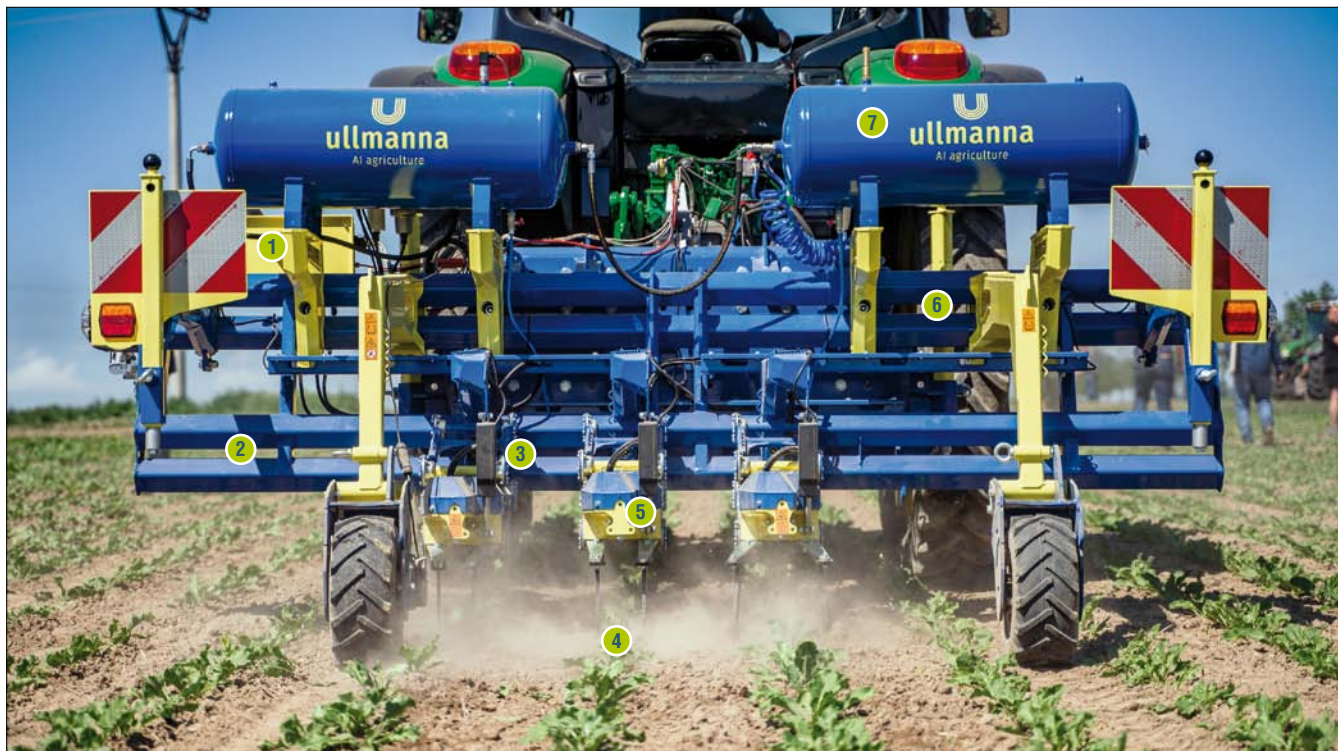
Obr. 7. Popis plečky Ullmanna vybavené AI technologií a strojovým viděním
