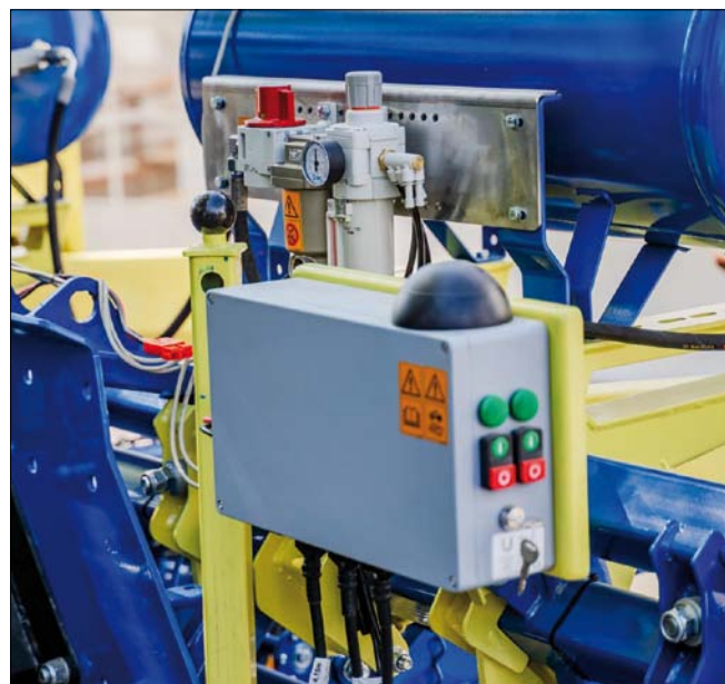
Obr. 5. PowerBox s centrální procesorovou jednotkou s polohovým systémem GPS a připojením k internetu
