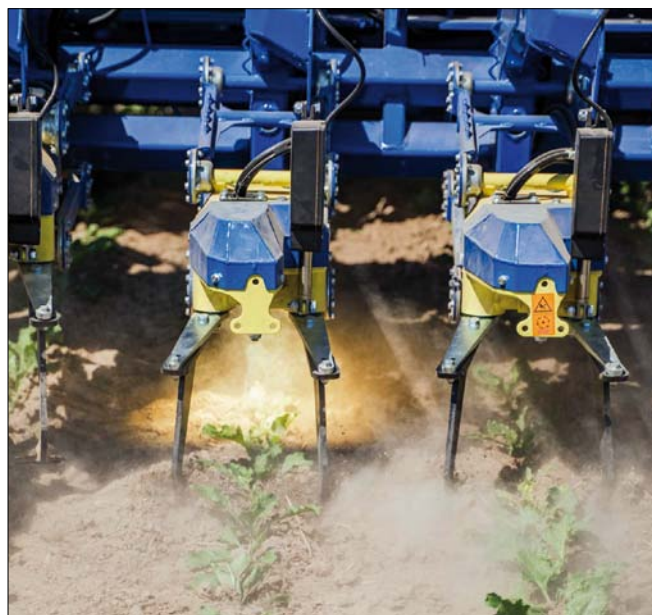
Obr. 2. Pracovní nástroje plečky s pneumatickými noži, nastavením jejich výšky a AROW boxy s osvětlením a kamerou
