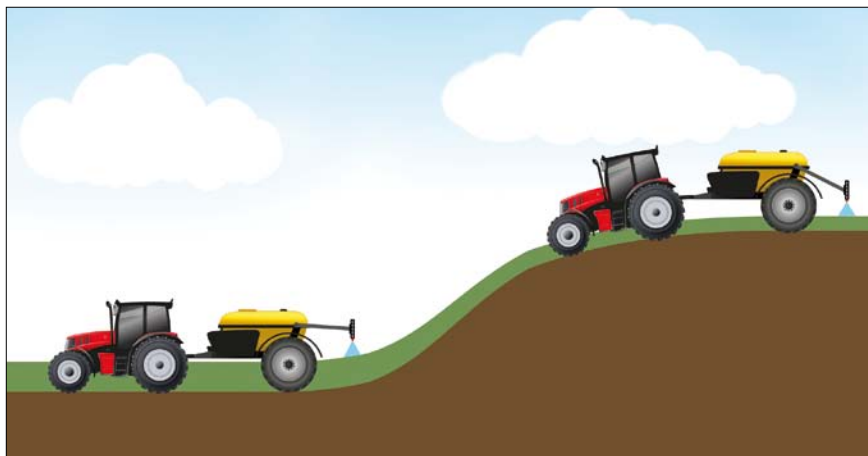
Obr. 3. Na kopci je nižší porost, ramena jsou níže, pod kopcem je porost vyšší, ramena postřikovače jsou výše
