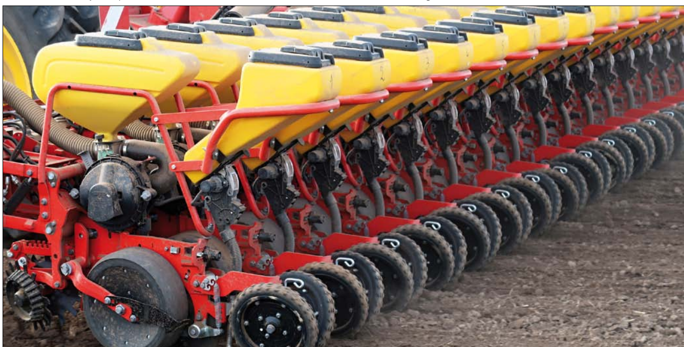
Obr. 1. Secí stroj Tempo TPL 18 MIDI Väderstad se zásobníkem na osivo a mikrogranulát
