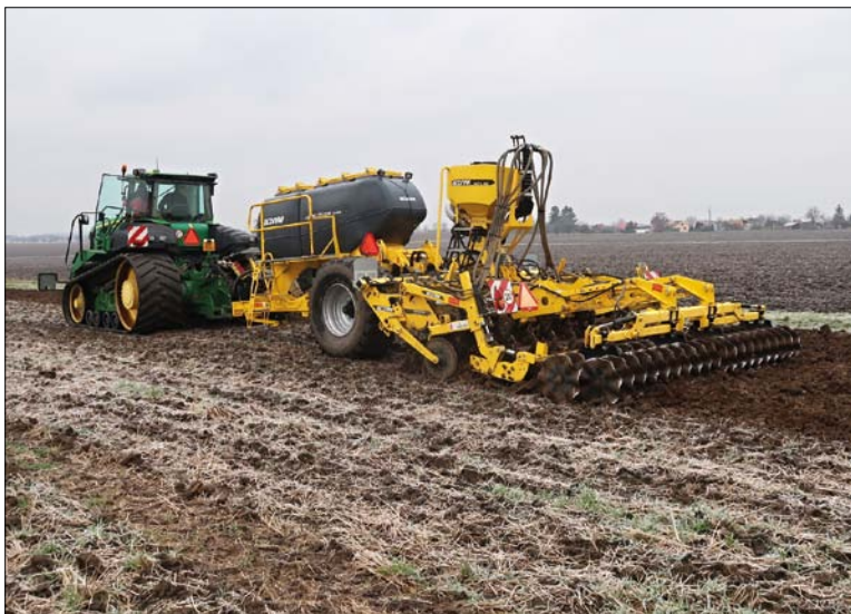
Obr. 3. Podzimní hluboké zpracování půdy dlátovým pluhem TerraStrip ZN
