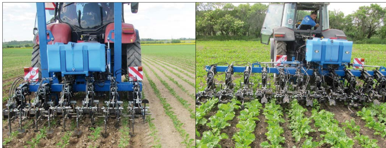
Obr. 7. Meziřádkové plečkování porostu cukrové řepy s důlkováním
