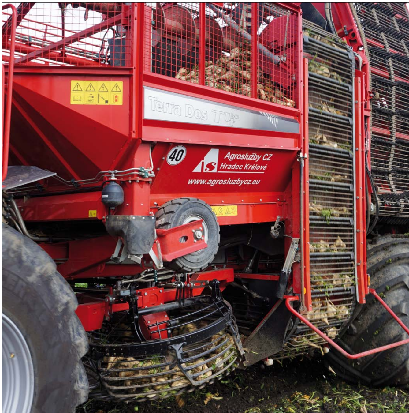
Obr. 7. Doprvník řepných bulev navazující na paprsková kola vyorávače
