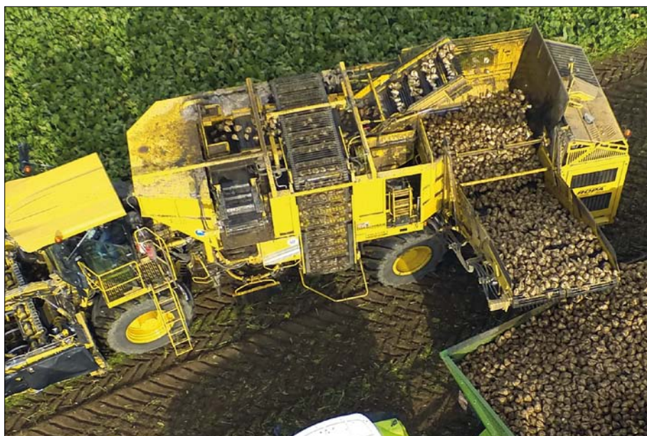
Obr. 1. Dopravníky řepných bulev sklizňového vyorávače
