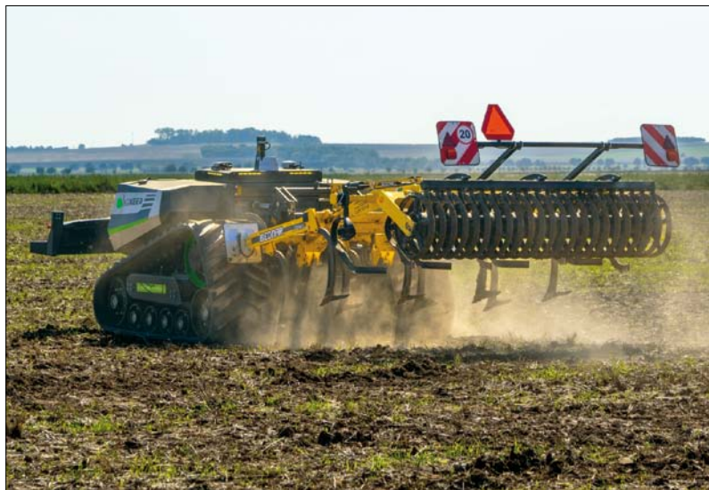
Obr. 2. Ukázka práce autonomního polního robota AgXeed AgBot 5.115T2
