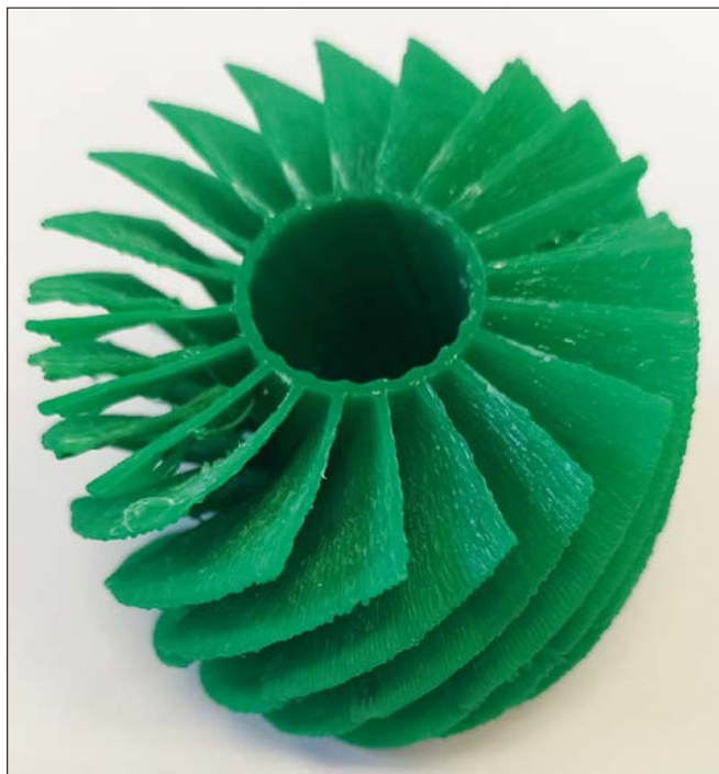
Obr. 5. Povrch 3D tištěných dílů z PLA
