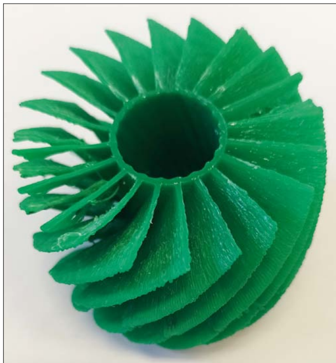
Obr. 5. Povrch 3D tištěných dílů z PLA
