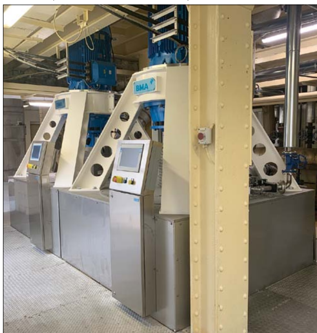
Obr. 10. Odštědivky BMA E1810-230, instalované letos v rámci OP PIK „Realizace energeticky úsporných opatření ve společnosti Cukrovar Vrbátky a. s.“
