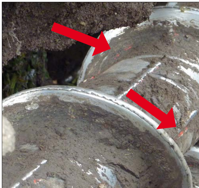
Obr. 2. Detail šneku nakládajícího ústrojí čistícího nakladače
