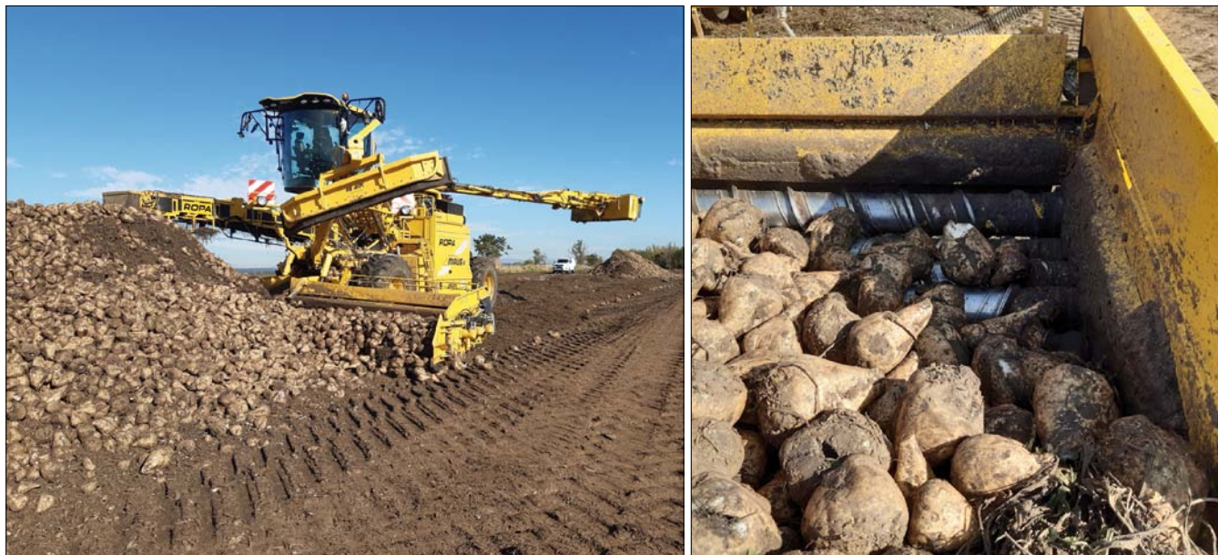
Obr. 1. Nakladač cukrové řepy a detail nakládacího ústrojí
