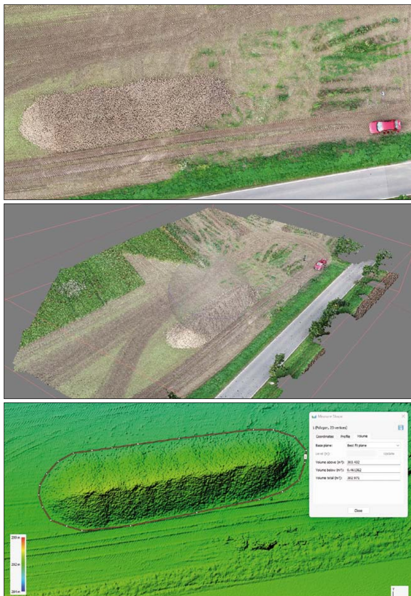
Obr. 9. Snímek hromady řepy (nahore), 3D náhled (uprostřed) a výpočet kubatury (dole)
