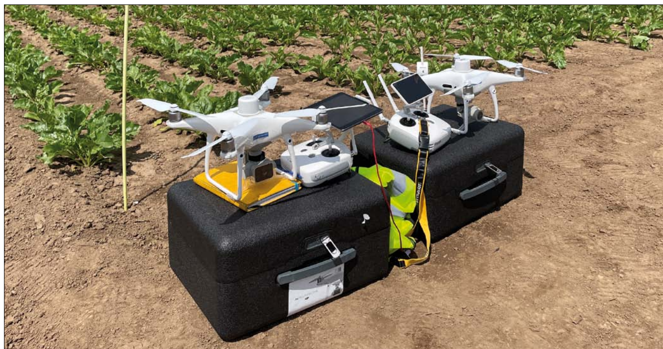
Obr. 1. Příklad moderních dronů – Phantom 4 RTK a Phantom 4 Multispectral pro RGB a multispektrální snímkování porostu – tyto drony obsahují RTK modul pro vysokou přesnost určení souřadnic
