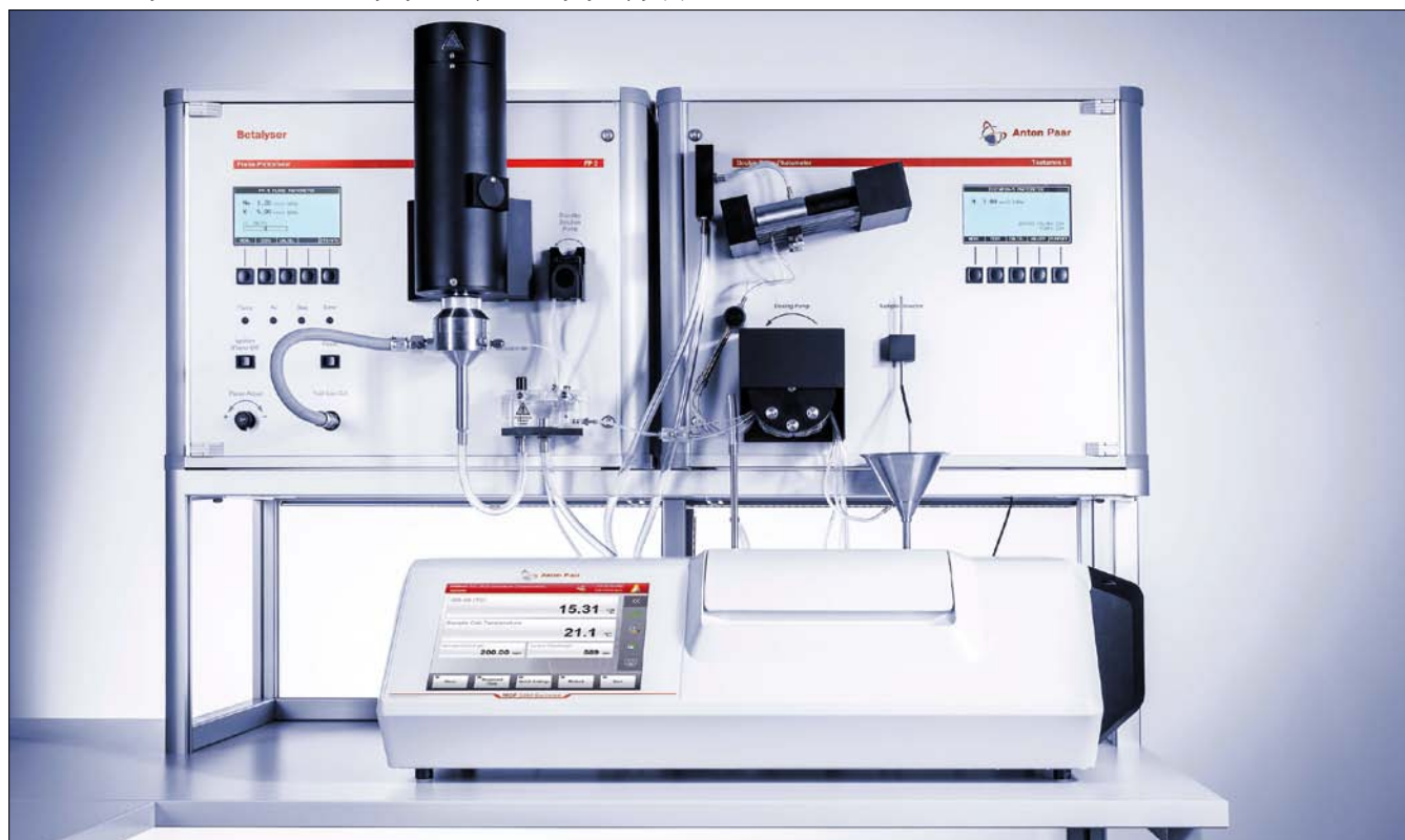
Obr. 1. Betalyser – automatizovaný systém pro analýzy řepy (1)
