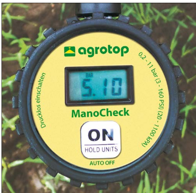
Obr. 3. Kontrolní manometr ManoCheck k měření tlaku na trysce
