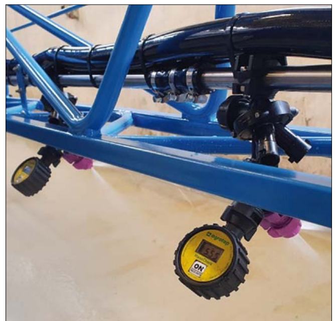
Obr. 4. Manometry ManoCheck na ramenu postřikovače
