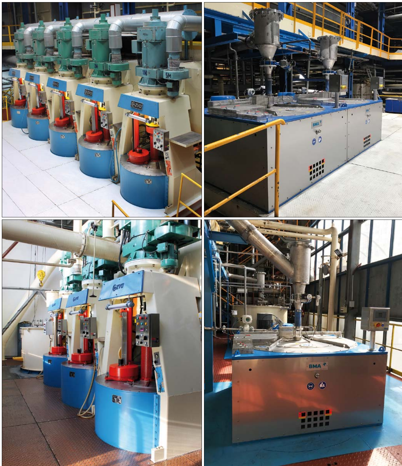
Obr. 6. Stanice odstředivek B produktu před a po modernizaci (nahore), stanice odstředivek C produktu před a po modernizaci (dole)
