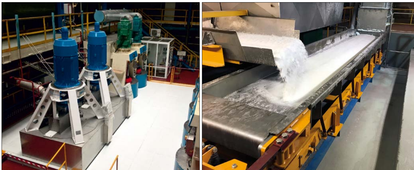
Obr. 5. Stanice odstředivek A produktu po modernizaci (vlevo) a dopravní cesta cukru (vpravo)
