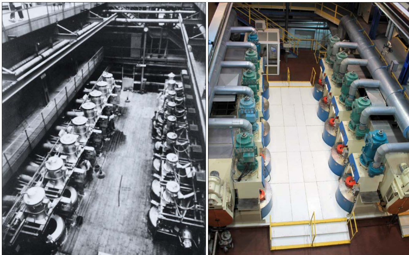
Obr. 1. Stanice krystalových a meziproduktových odstředivek v opavském cukrovaru – vlevo stanice Weston (60. léta), vpravo ARO 88-1250 (90. léta)
