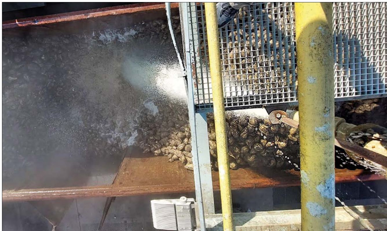
Obr. 4. Příjem řepy v hrušovanském cukrovaru po železnici – plavení vagonovou Eflou
