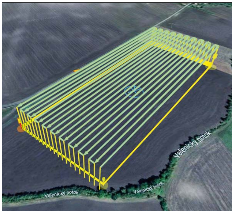
Obr. 4. Letová dráha dronu na pokusné lokalitě
