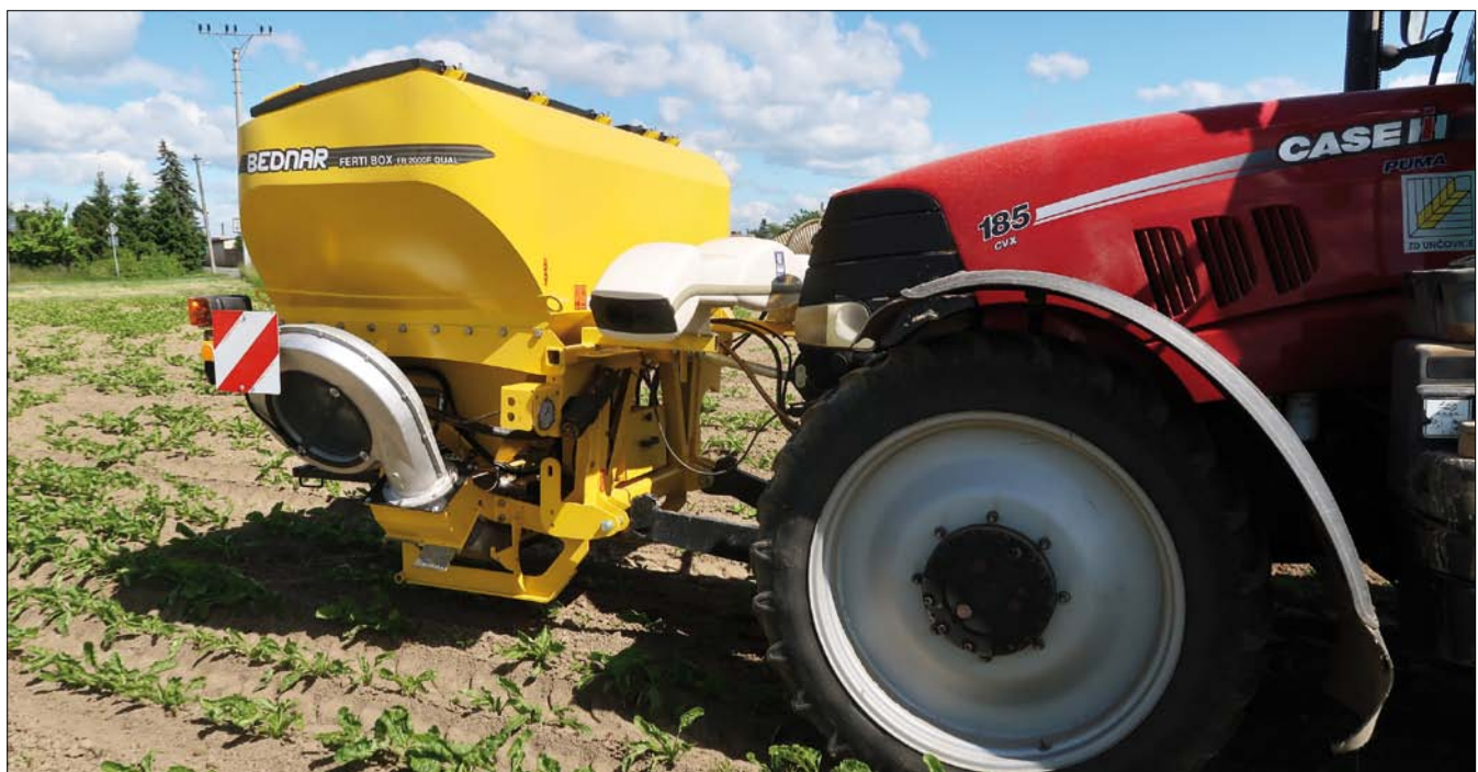
Obr. 1. Yara N-Sensor ALS s vlastním zdrojem světla a s dávkovacím zařízením a zásobníkem na hnojivo
