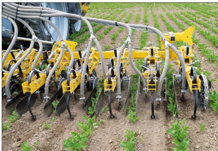
Obr. 3. Meziřádek kypří dvě radličky, které současně ukládají hnojivo do půdy co nejbliž k rostlině a třetí radlička kypří prostor uprostřed a pracuje nejhluběji
