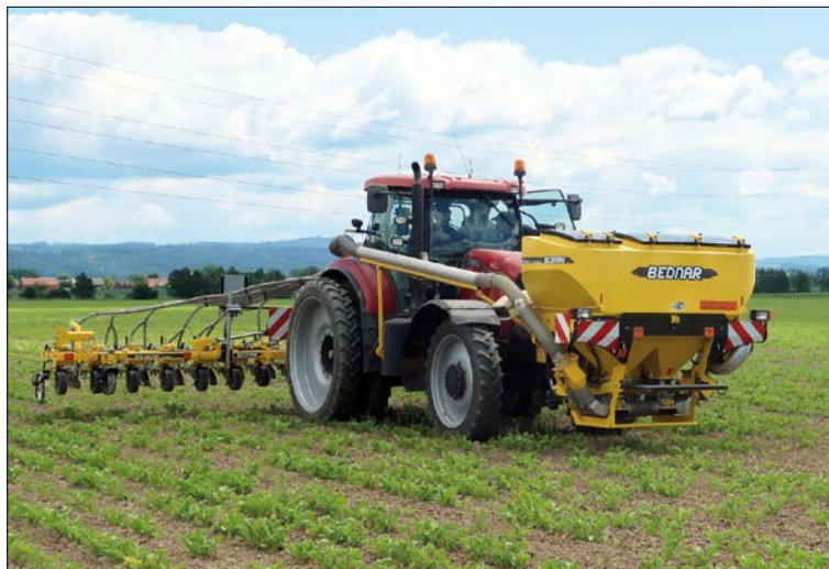
Obr. 2. Příprava N-senzoru pro variabilní přihnojení – ten načítá variabilitu porostu pro nastavení citlivosti senzoru pro variabilitu dávky hnojiva
