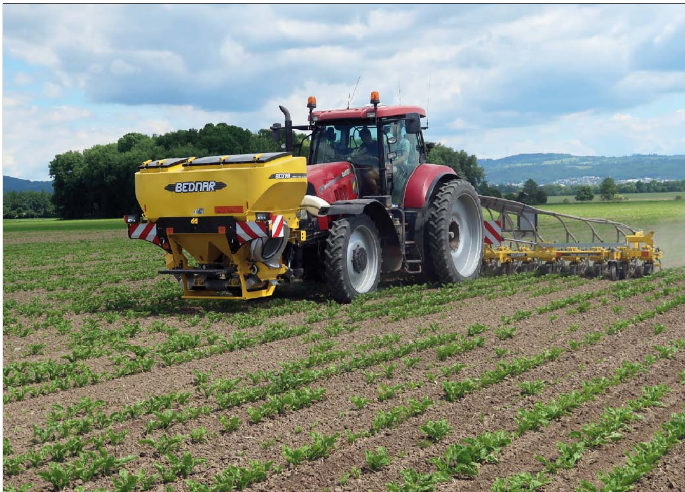
Obr. 6. Souprava pro variabilní přihnojení se zapravením hnojiva do půdy při plečkování
