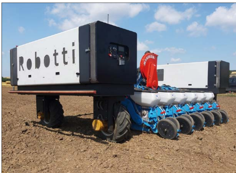
Obr. 1. Roboty lze využít při přesném setí, také pro plečkování a přívěs meziplodin
