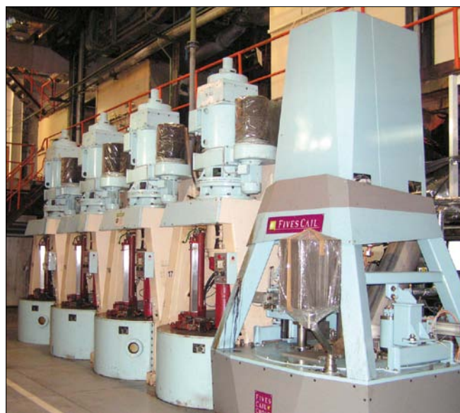
Baterie automatických recyklujících odstředivek
