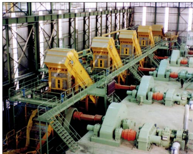
Mlýnská stanice ve třtinovém cukrovaru s pěti šestiválcovými mlýny
