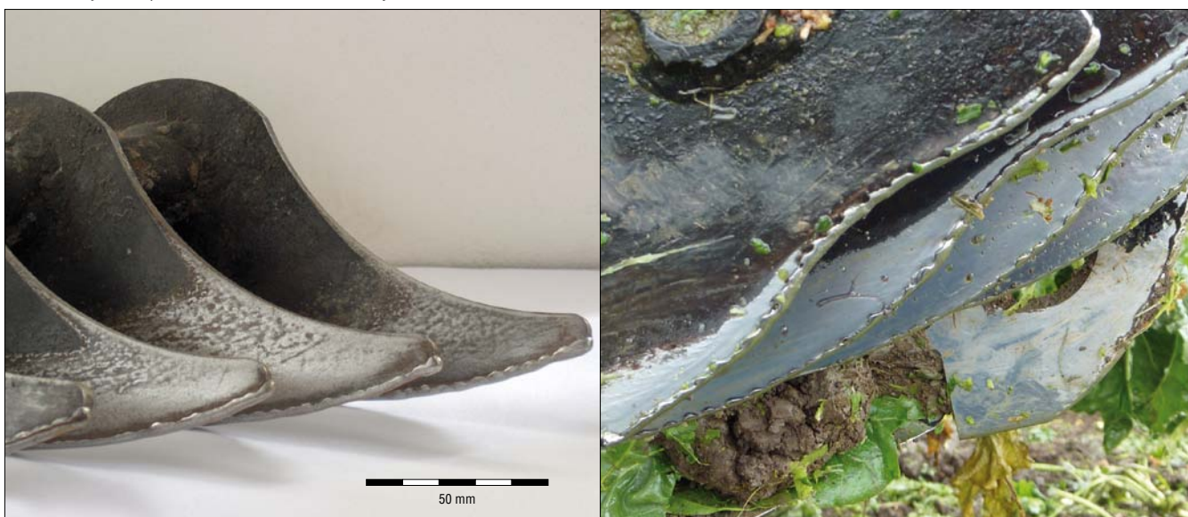
Obr. 1. Systém plazového hmatače u strojů Holmer
