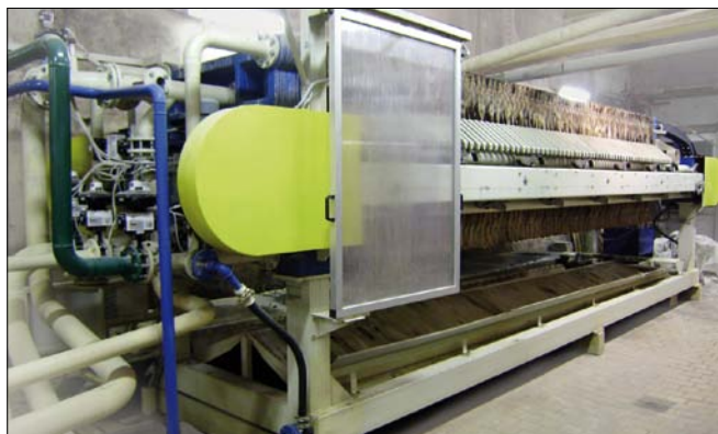
Komorový filtr – kalolis konstrukce VUC Praha v cukrovaru Vrbátky
