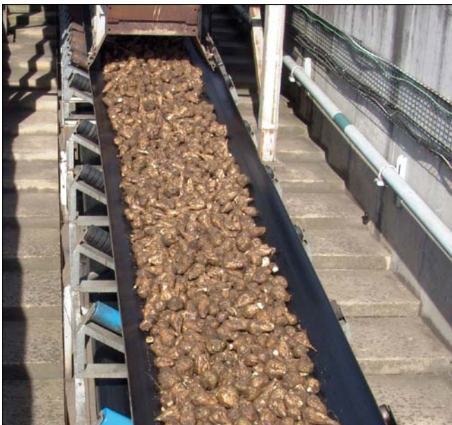
Pásový dopravník cukrové řepy v dobrovickém cukrovaru
