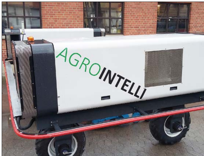
Obr. 3. Robotický nosič nářadí od dánské společnosti Agrobotelli
