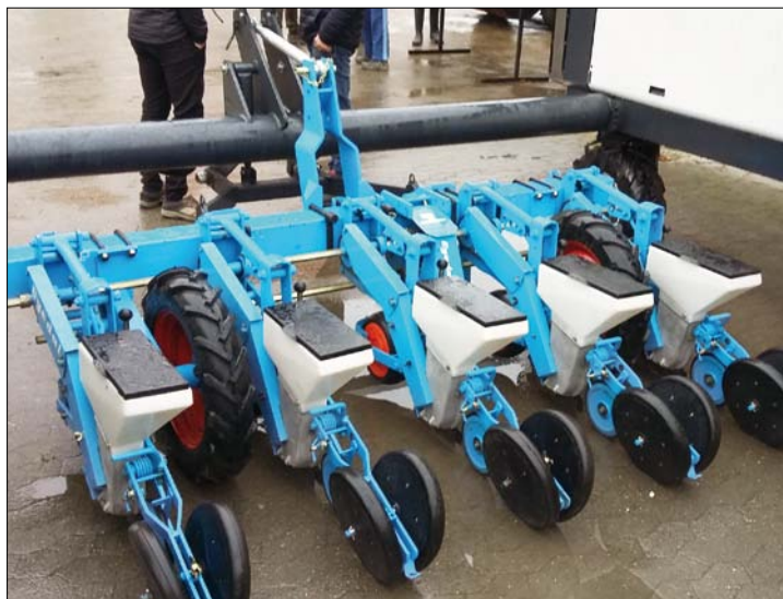
Obr. 4. Ukázka zavěšení pracovní sekce na stroji Agrobotelli Robotti
