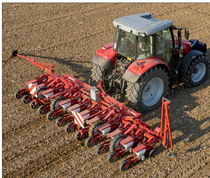
Obr. 1. Kverneland Unicorn – 12řádkový se sklopným rámem
