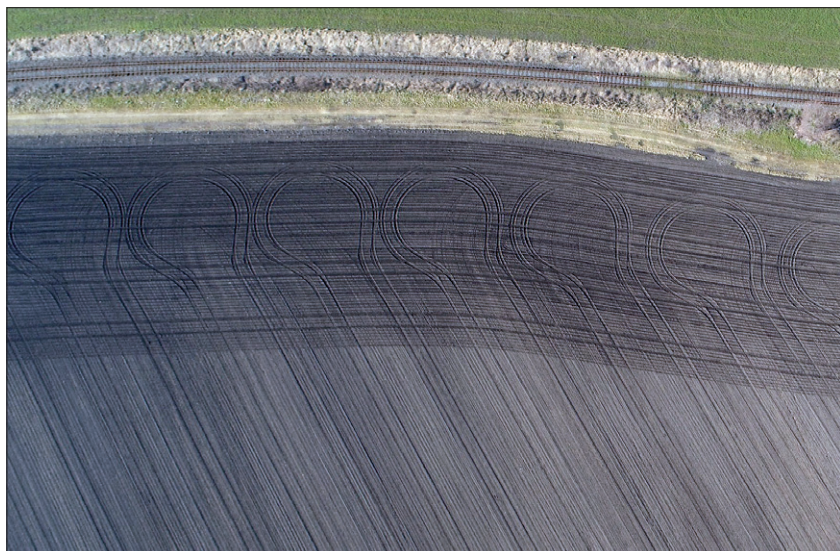
Obr. 3. Stopy automatického otáčení na souvratí (foto Herčík)
