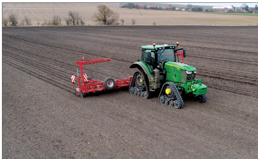
Obr. 2. Technologie GPS zamezí zbytečným přejezdům po pozemku a přesevům na souvratích (foto Herčík)
