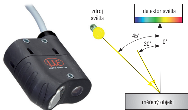
Obr. 2. Standardní senzor ACS systému colorCONTROL ACS7000 (upraveno podle www.micro-epsilon.cz )
