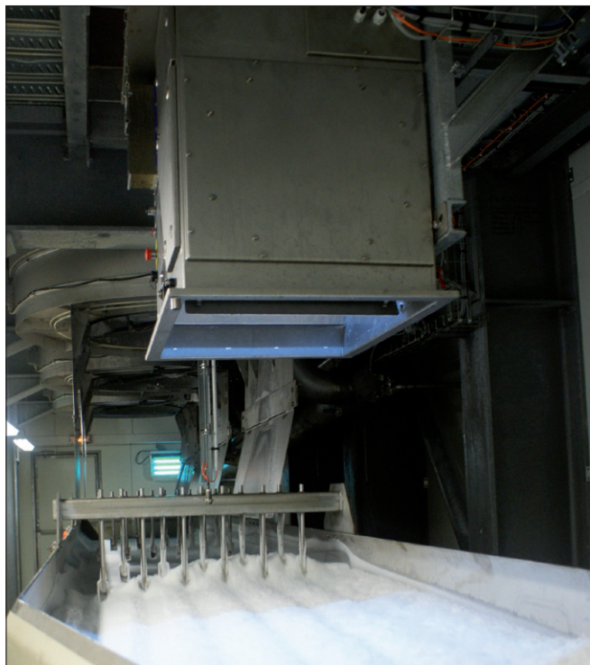
Obr. 6. Přístroj Colobserver® (Iteca Socadei, France) instalovaný nad pásový dopravník vlhkého cukru za odstředivkami
