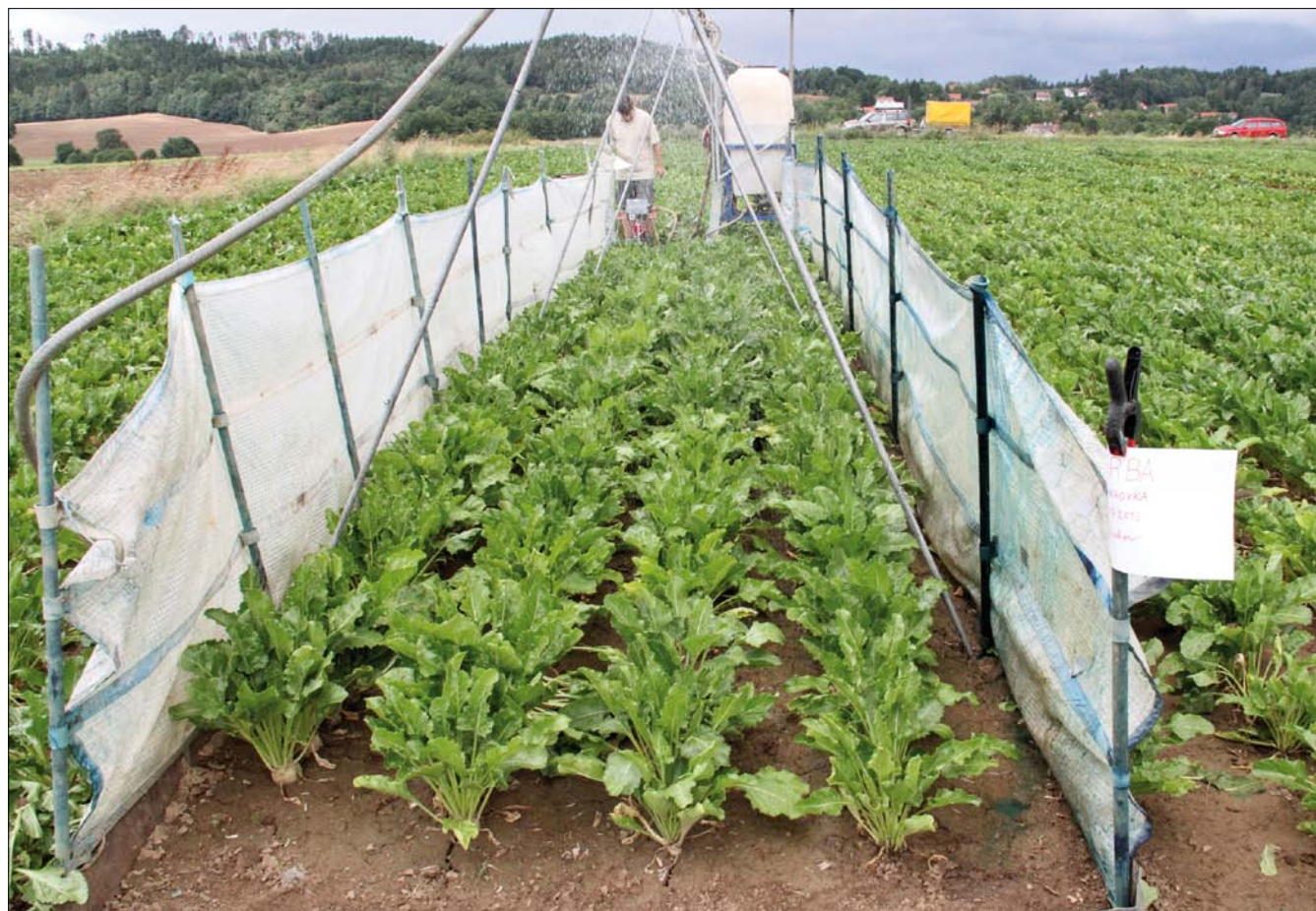
Obr. 3. Hodnocení vlivu kypření na vodní erozi půdy – zadešťování
