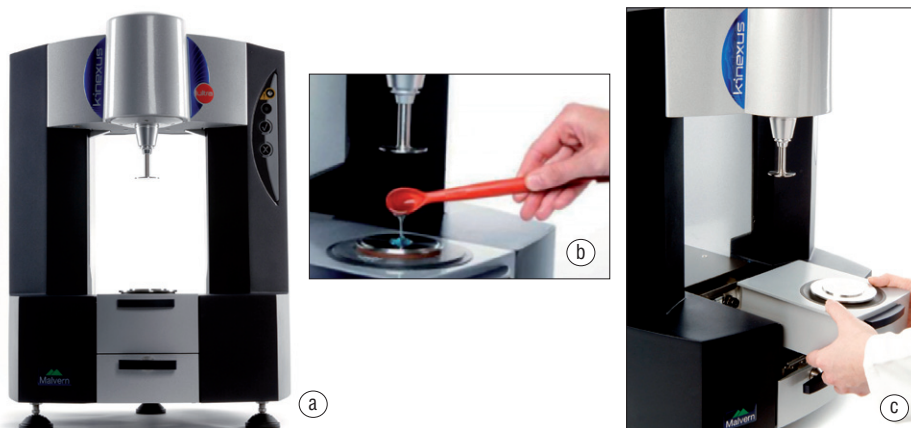
Obr. 8. Rotační reometr Kinexus (podle www.malvern.com )
