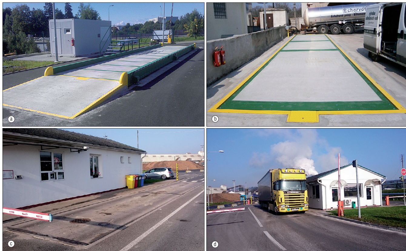
Obr. 9. Váhy pro silniční vozidla: a) nájezdová mostní váha Profi Universal, b) zapuštěná mostní váha Profi B (www.vahyjas.cz), c, d) silniční váhy v cukrovaru Dobrovice, Tereos TTD, a. s. (foto V. Pour)
