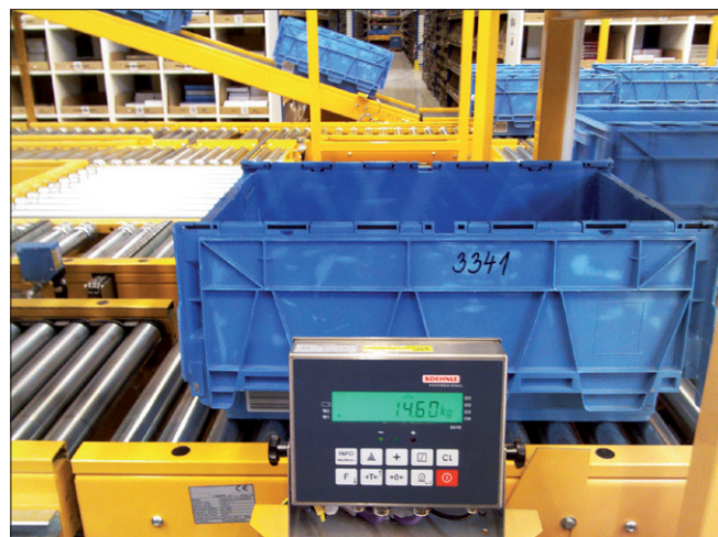
Obr. 8. Příklad automatizovaného vážního systému ve válečkové trati ( www.vahynetto.cz )
