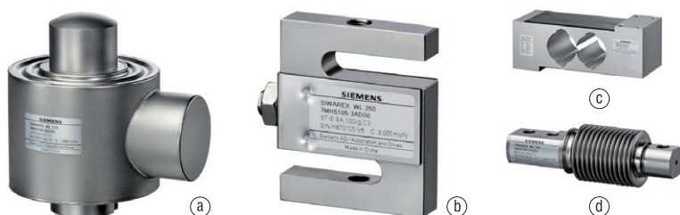
Obr. 3. Snímače zatížení typové řady Siwarex (4): a) kompresní snímač zvláště vhodný pro zásobníkové a vozidlové váhy, b) snímač vhodný pro vážení nádrží a zásobníků, c) snímač vhodný pro malé a střední plošinové váhy, d) snímač s ohýbaným nosníkem vhodný pro menší zásobníky a plošinové váhy
