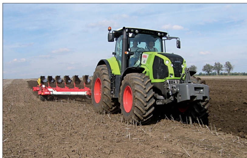
Obr. 4. Orební souprava traktoru CLAAS Axion 850 s 8radličným otočným pluhem Pöttinger 6.50 PLUS NOVA 8 SCH
