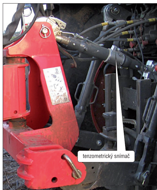
Obr. 5. Tenzometrický snímač síly Hottinger (HBM) v horním táhle TBZ
