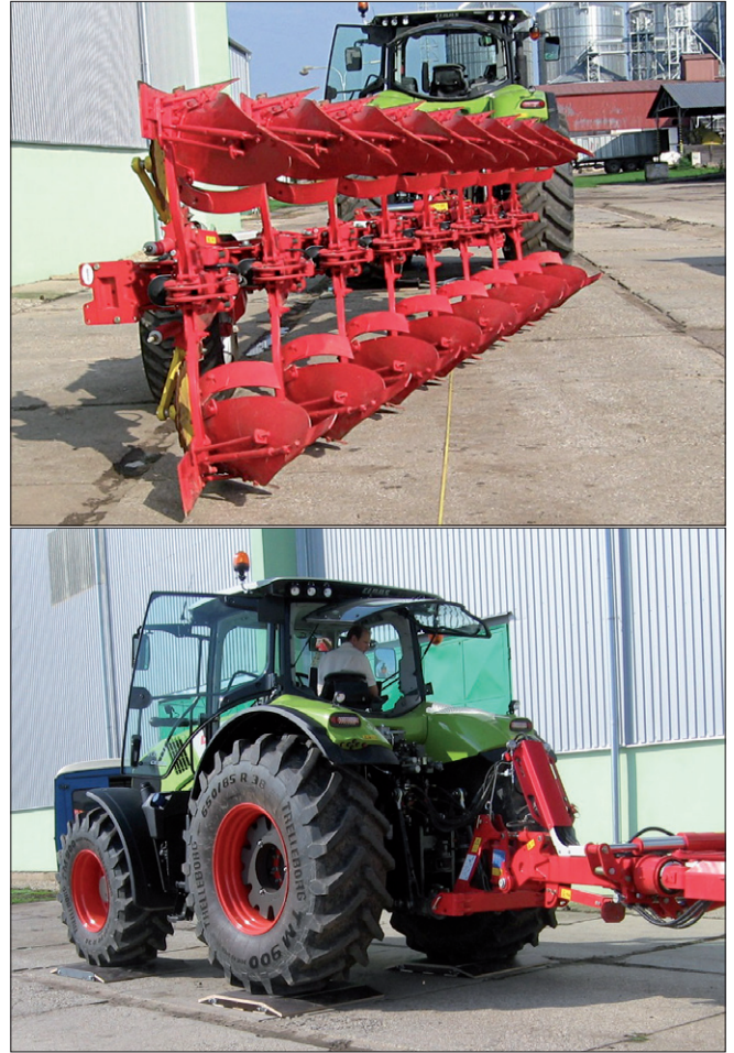
Obr. 2. Vážení orební soupravy na nájezdových vahách
