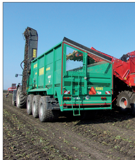
Obr. 4. Vyvážecí vůz HAWE RUW 4000
