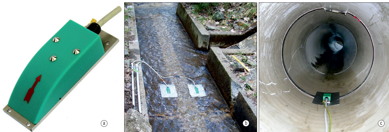
Obr. 5. Měření průtoku indukčním snímačem MAG-Flow OG-P ( www.goerlichgmbh.com ): a) snímač MAG-Flow OG-P, b) měření v otevřeném kanálu, c) měření v odpadním potrubí, (foto poskytla firma POLZ Instruments s.r.o., www.polz.cz )
