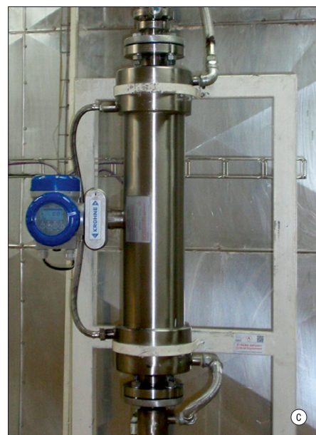
Obr. 5. Příklady instalací Coriolisových průtokoměrů v průmyslových provozech: a) průtokoměr Siemens Sitrans (www.siemens.cz) – lihovar Dobrovice, Tereos TTD, a. s.; b) průtokoměr ABB TRIO-MASS (www.abb.cz/mar) – průtok řediny v lihovaru Dobrovice, Tereos TTD, a. s., (foto M. Kmínek); c) průtokoměr Krohne Optimass (www.krohne.cz) – průtok kakaového másla v závodě Zora Olomouc (foto Nestlé)
