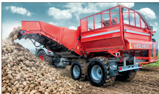
Obr. 3. Boční vykládání na skládku řepy
