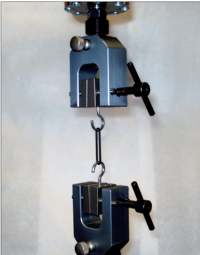
Obr. 2. Měření tahových vlastností O-kroužků
