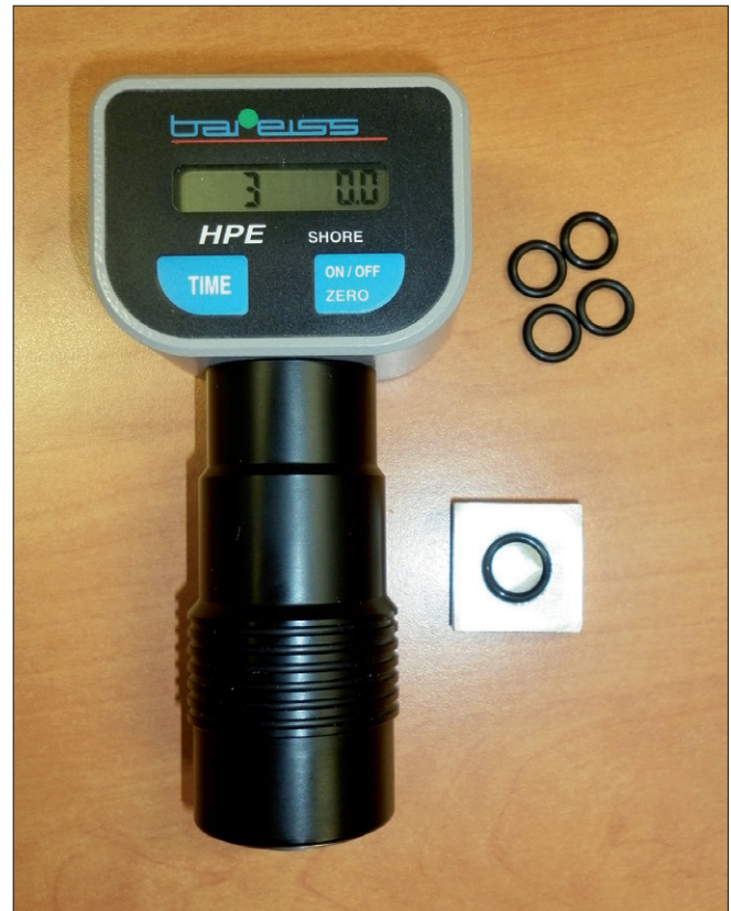
Obr. 3. Přípravek k měření tvrdosti Shore A O-kroužků
