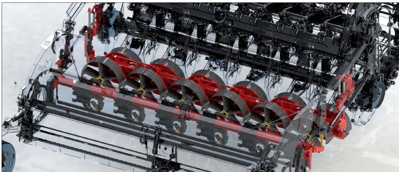
Obr. 4. Model uspořádání nového systému odstranění chrástu
