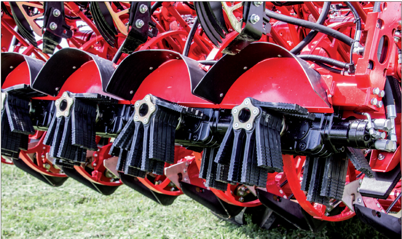
Obr. 1. Gumové paličky kombinovaného mechanismu odstranění chrástu pracují podél směru jízdy
