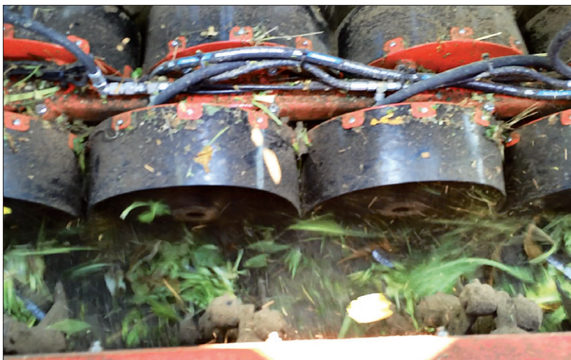
Obr. 2. Dvě proti sobě jdoucí čistící hřídele v činnosti
