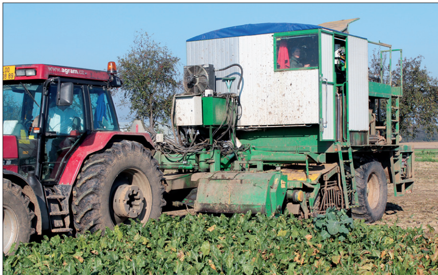
Obr. 5. Sklizeč pokusů s cukrovou řepou postavený na bázi sklizeče Stoll V300
