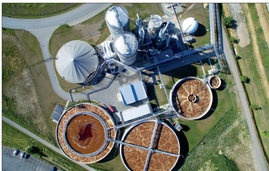
Obr. 4. Čistírna lihovarnických výpalků v dobrovickém areálu produkuje bioplyn
